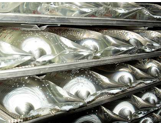
Illustration : Tuilage des poches sur les plateaux de stérilisation d'un autoclave air-vapeur
